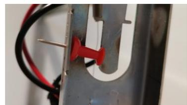
7. Sortez les 2 pattes puis y glisser les 2 connecteurs d'entrée et de sortie du courant en les bloquant avec chacune des pattes
