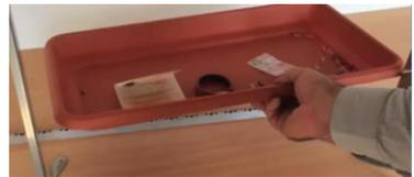
4. Insérer la tringle du bas dans les encoches situées au-dessus du bac. L'assemblage n'assure pas un maintien ferme, c'est tout à fait normal. Une fois que les fils seront montés, leur tension tiendra la tringle bien en place.
