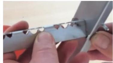
5. À l'aide d'une pince, sortez la patte située au-dessus de la tringle basse de façon à la positionner à la perpendiculaire du cadre. Elle sera utilisée pour le montage des fils.
